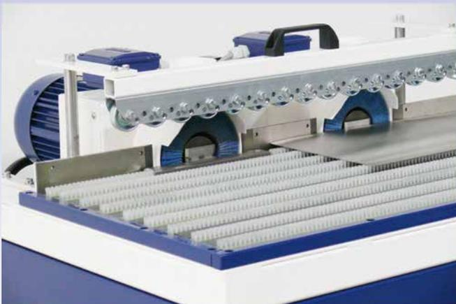
Zwei Aggregate mit gegenläufig arbeitenden Werkzeugen. Druckbalken mit Rollen zum sicheren Halten der Blechteile. Werkstückschonende Tischauflage aus Bürstenleisten.
