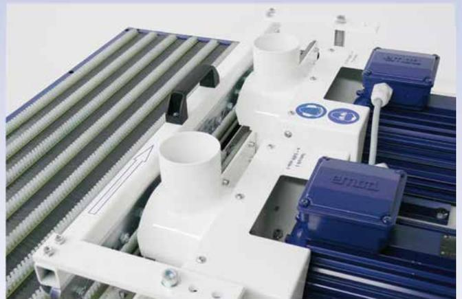
Die Aggregate sind mit je einer Absaughaube mit Absaugstutzen ausgerüstet und müssen an eine externe Absauganlage angeschlossen werden.
